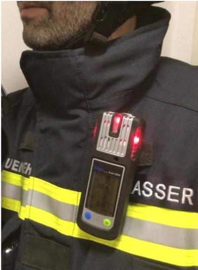
Aufgrund zunehmender Unfälle, verursacht durch erhöhte Konzentrationen an lebensfeindlichen Gasen, wurde ein Mehrgaswarngerät der Firma Dräger angeschafft.
